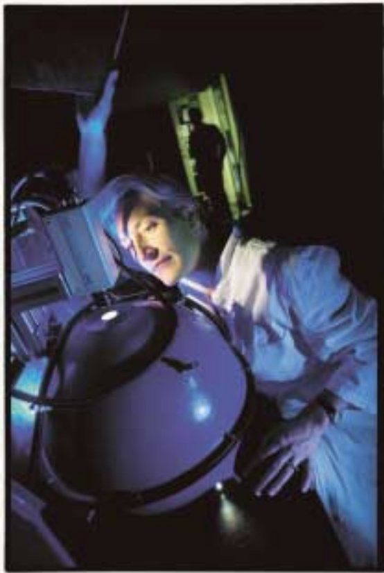
DTU's industrielle billedlaboratorium på IMM udvikler ny visionsteknologi til industrielle anvendelser. Her ses en løsning til kamerabaseret præcisionsfarvemåling.
